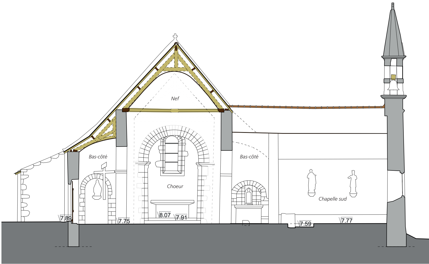
Coupe transversale du choeur et de la nef avec la tribune au 1/100°
