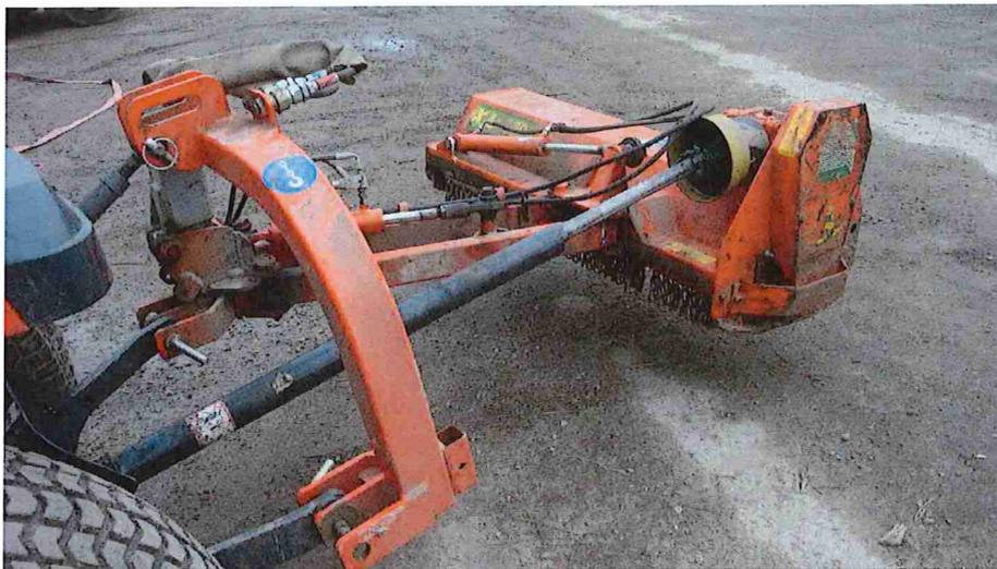
Epareuse permettant de traiter les bandes latérales de part et d'autre des chaussées (largeur dite de sécurité)
